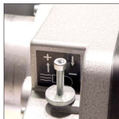
fig. 16 : Regelschroef luchtstroom (fijnafstelling)
